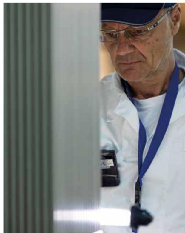
Contrôle visuel d'un assemblage combustible
