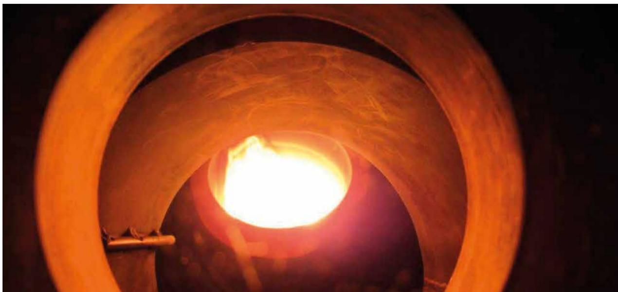
Fusion d'un barreau d'alliage Zirconium-Uranium dans l'atelier TRIGA (voir encadré ci-dessous)
